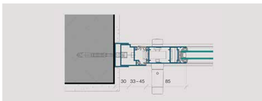
Horizontalschnitt mit Bedienungsflügel, einwärts öffnend
