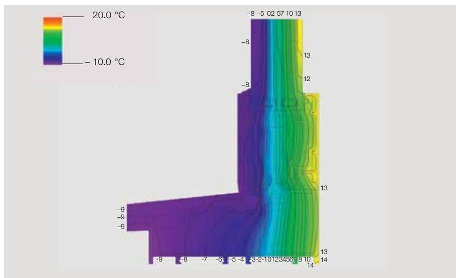
Isothermendiagramm des Schiebeflügels mit therm. optimiertem Kunststoff-Randverbund und Glas U<sub>G</sub> 0.6 W/m<sup>2</sup>K
