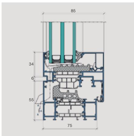
Vertikalschnitt IS-4-Fenster unten
